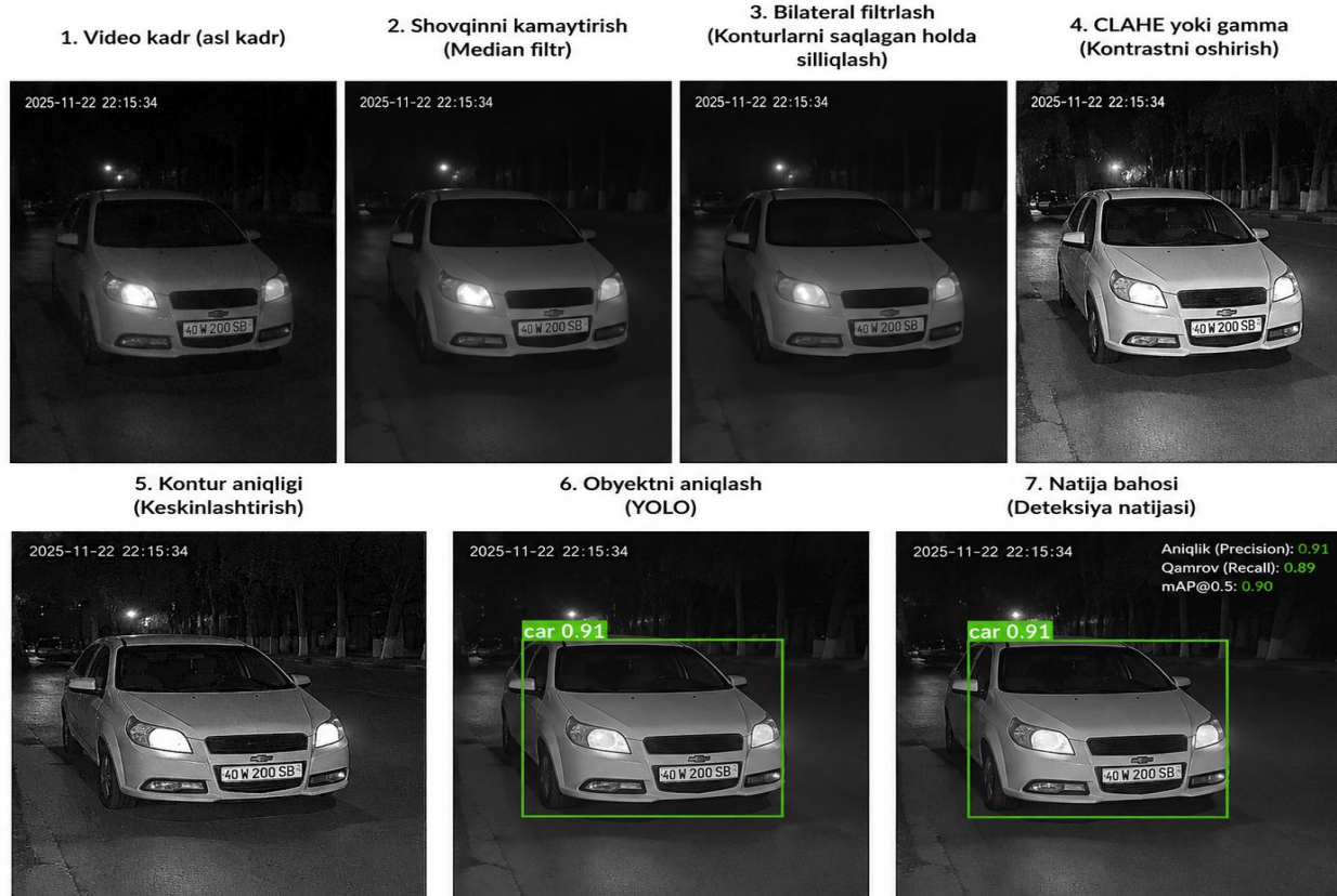
1-rasm. Tungi videokadrni qayta ishlashning tavsiya etilgan ketma-ketligi
